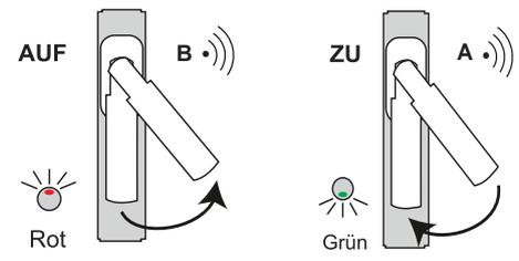
Die Betätigung der Taste (C) am Fenstergriffkontakt sendet den Status der Griffstellung AUF oder ZU aus und zeigt diese durch die LED an. LED leuchtet ROT bedeutet, Griffstellung ist AUF. LED leuchtet GRÜN bedeutet, Griffstellung ist ZU. Damit kann der richtige Einbau der Magnetscheibe (B) geprüft werden.
