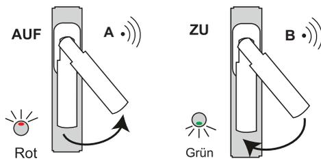
**AUS/EIN (RTS26E5001B03):** Beim Öffnen des Fensters wird der Easywave-Code B (AUS) und beim Schließen ein Easywave-Code A (EIN) gesendet.
