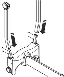
3. Ziehen Sie die auf beiden Seiten des Rahmens befindlichen 6-mm-Schrauben mit Hilfe des mitgelieferten Inbusschlüssels fest.
