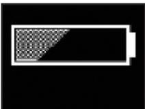
Wenn auf dem Display eine halb leere Akku angezeigt wird, heißt das, dass der Akku aufgeladen werden muss.
