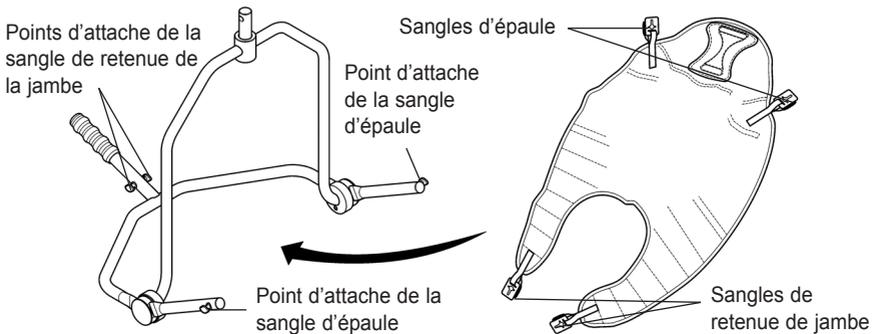
**Chassiss à 4 points de fixation.** Exemple d'une courroie pour chassiss à 4 points dotée d'attaches sécuritaires.
