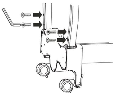
4. Introduisez la partie courbée de la flèche dans le support de celle-ci. Fixez l'ensemble en insérant les deux vis à têtes fraisées plates de 6 mm dans la plaque de couverture bleue fournie avec le kit de fixation, comme indiqué ci-dessous, et serrez fermement.
