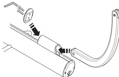
5. Befestigen Sie das Vierpunktgestell durch Einsetzen des Spannstifts am Ausleger des Lifters. Vergewissern Sie sich, dass der Stift sicher montiert ist.
