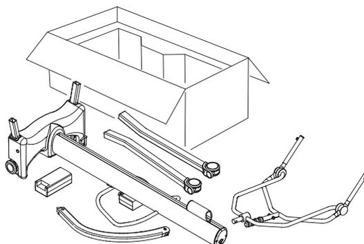
2. Adaptez les pieds au châssis à l'aide de deux vis à têtes fraisées plates de 6 mm par pied, comme fourni.
