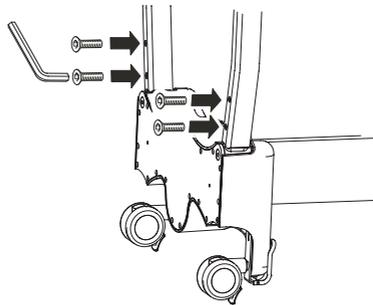
4. Setzen Sie den gekrümmten Auslegerabschnitt in den Auslegerschlitten ein. Befestigen Sie die Baugruppe, indem die beiden 6-mm-Senkschrauben wie unten gezeigt in das mit dem Befestigungs-Kit gelieferte blaue Abdeckblech eingesetzt und festgezogen werden.
