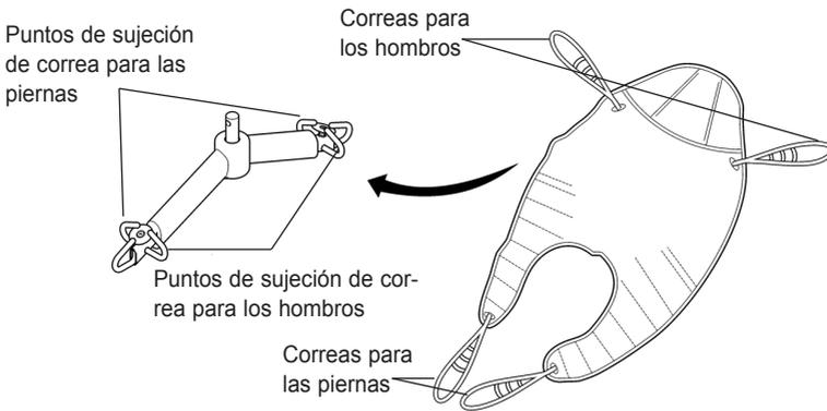
**Barra de extensión de 6 puntos:** Ejemplo de la barra de extensión de 6 puntos con sujeciones de bucle.
