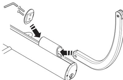
5. Instale el bastidor de posición de cuatro puntos en el larguero de elevación insertando la chaveta hendida. Asegúrese que la chaveta está bien fija.
