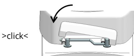
Die HYTO Sitzerrhöhung ist fertig montiert!
