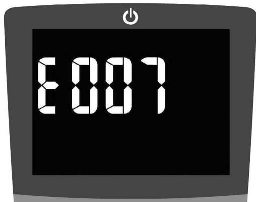
Jusqu'au message d'erreur E127, l'unité de commande et d'affichage affiche le message d'erreur pendant 3 secondes environ. Puis l'appareil redémarre.
